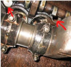
*Beide Stöpsel habe ich erneuert, das heißt, stufenweise angebohrt und habe dann dort hinein ein 8 mm Gewinde geschnitten. Mit einer langen 8er Schraube ließ sich der durchkorrodierte Stopfen leicht herausziehen. Der zweite saß fester. Die neuen Verschlüsse habe ich mir aus 2 alten Topo-Radbremsszylinderkolben gedreht. Die Öffnung im Block ist ca. 17 mm zylindrisch, den Bund habe ich bei 20 mm Durchmesser und 3 mm Höhe belassen. Durch die konische Vertiefung im Bremskolben verbleibt*
