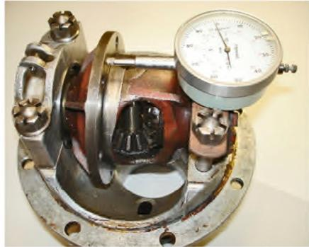
Tellerrad geprüft werden. Dazu das Differentialgehäuse mit den Lagern in das Getriebegehäuse einbauen und die Lager leicht vorspannen. Dann mit einer Messuhr den Rundlauf prüfen.
