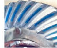
Am einteiligen Achsantrieb mit Stahlguss-Gehäuse muss deshalb das Kegelrad ausgebaut werden und das Lager mit einer Trennvorrichtung abgezogen werden.
