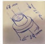
*nach dem Abdrehen eine Höhe von ca. 12 mm. Die 17 mm Durchmesser habe ich mit 0,5 mm Übermaß zum Bund leicht konisch gedreht. Die Bohrung im Block ließ sich schlecht messen, da die Alteile verformt waren. Mit 2-Komponentenkleber ließen sich die Pfropfen stramm einschlagen, wobei der Bund erst nach massiven Schlägen mit Hilfe eines langen Werkzeugdorns zum Anliegen kam. Nach dem Aushärten des Klebers wurde mit Druckluft, wie anfangs, die Dichtheit geprüft.*
