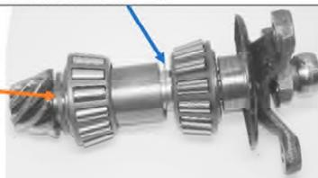
vorsichtig angezogen. Lässt sich das Kegelrad nur schwer drehen muss eine dickere Scheibe oder eine Scheibe zusätzlich eingebaut werden. Das Kegelrad muss bei geölte Lagern mit leichtem Widerstand drehbar sein. Wenn das Kegelrad sich leicht drehen lässt, wird die Kugelmutter mit 140 Nm angezogen. Hierbei mit Werkzeug gegenhalten, um den Mitnehmer nicht zu verbiegen.
